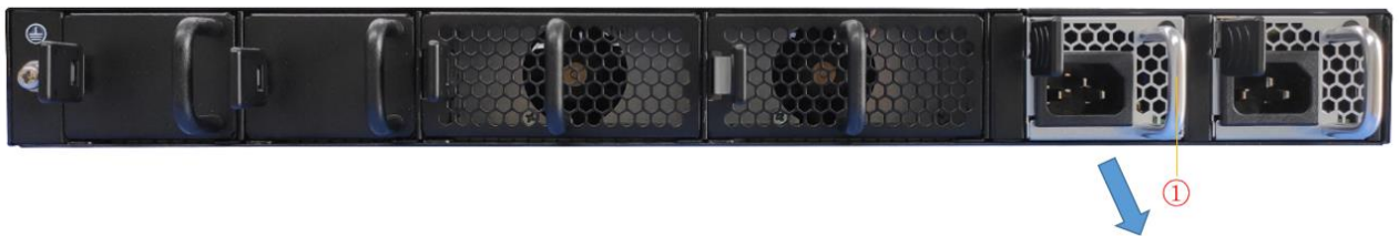
图 2-6 电源模块拆卸示意图
