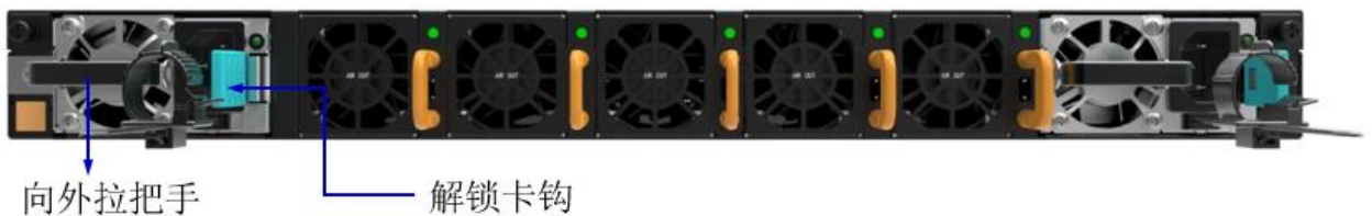
图 2-5 电源模块拆卸示意图
