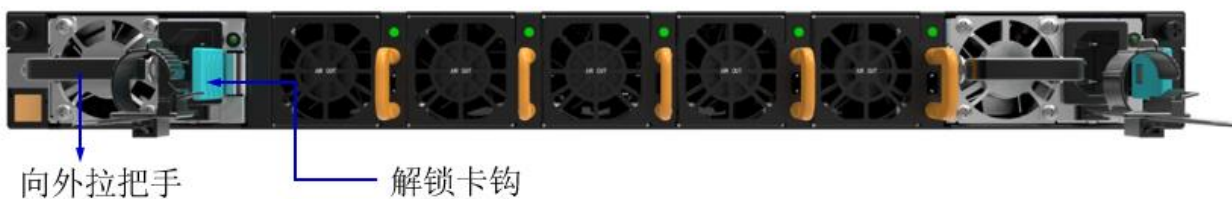
图 2-5 电源模块拆卸示意图
