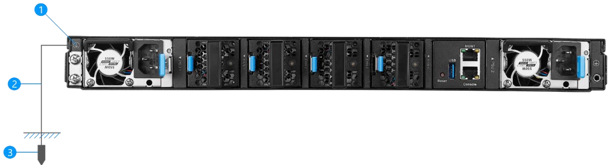
图 2-3 交换机接地线安装示意图
