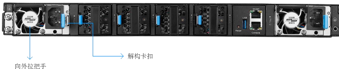
图 2-1 e 电源模块安装示意图
