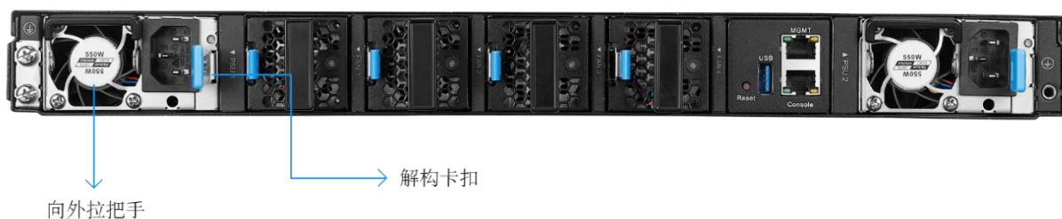
图 2-2 电源模块拆卸示意图
