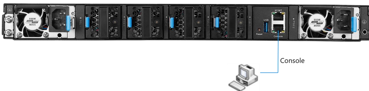
图 3-1 通过 Console 口搭建本地配置环境
