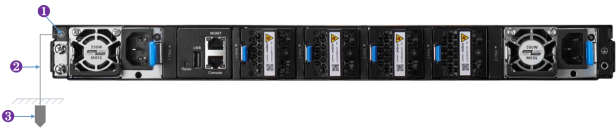
图 2-3 交换机接地线安装示意图
