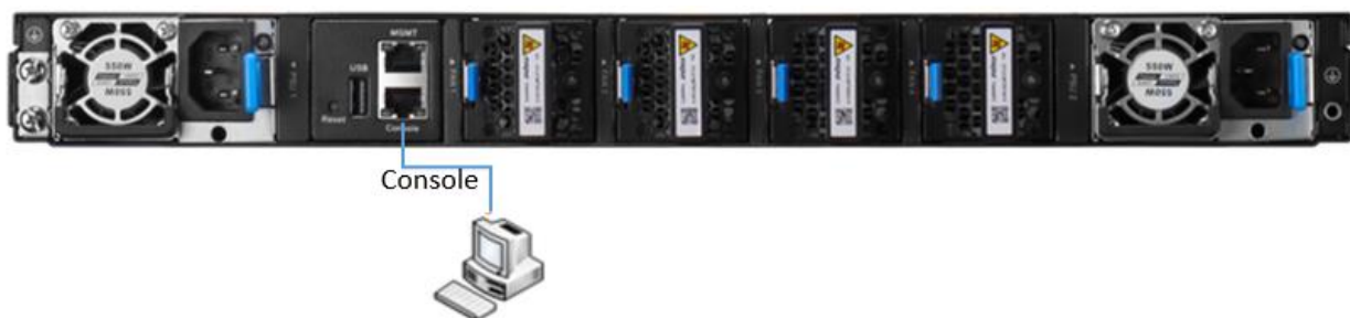
图 3-1 通过 Console 口搭建本地配置环境
