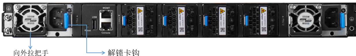
图 2-1 e 电源模块安装示意图
